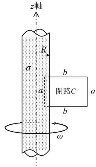
図2 角速度  $\omega$  で回転する半径  $R$  の無限長円筒
