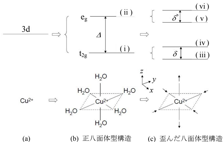
図2  $\text{Cu}^{2+}$ の水和構造(下)と対応する3d電子のエネルギー準位(上)の模式図
