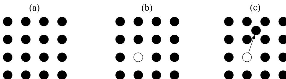
図 4 (a) 完全結晶と(b), (c) 格子欠陥モデル.
