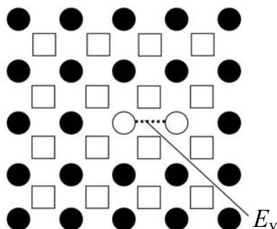
図 5  $\text{M}_{1-x}\text{O}$  の結晶構造. □は酸素原子,
