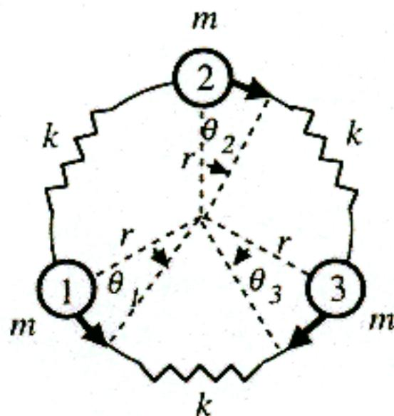
問 A 3 つの質点の平衡位置からのずれを円の中心からみた反時計回り方向のずれ角  $\theta_1, \theta_2, \theta_3$  で記述する。ずれ角は十分小さいため、バネの位置エネルギーは半径  $r$  の円周上の円弧の長さの変化の 2 乗にのみ依存するとする。このときのラグランジアンと  $\theta_1, \theta_2, \theta_3$  に関する運動方程式を求めよ。
